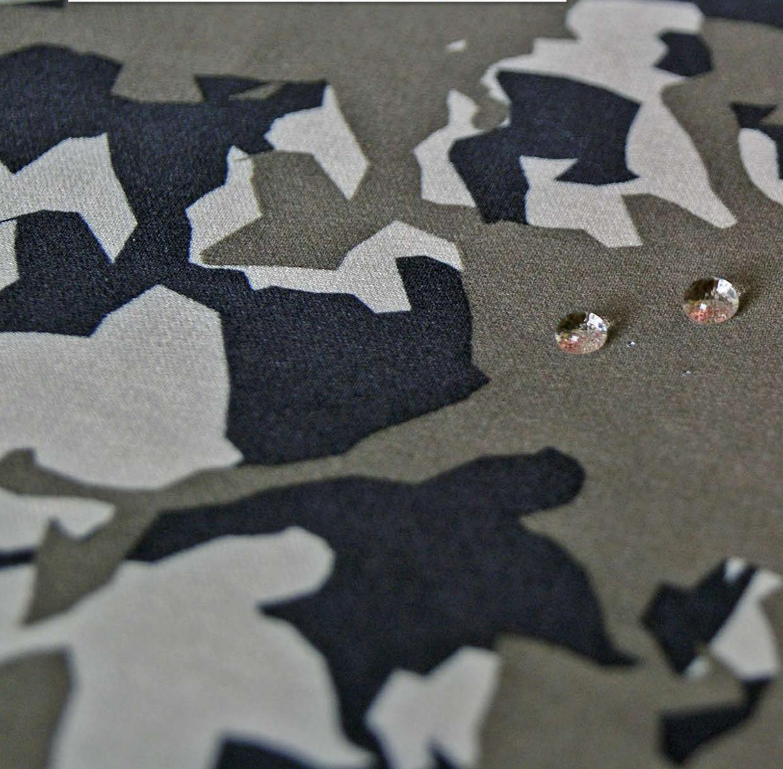
La segunda verificación fue la resistencia al agua del material Onca Shell con una sencilla, pero contundente prueba: verter agua sobre el tejido y cotejar su repelencia. Gracias al hidrofugado a base de Teflón con el que se elabora el tejido, el agua resbala totalmente y no moja las fibras. Esta particularidad se ha conseguido variando la superficie de mojado del tejido, por lo que las gotas de agua apenas lo rozan y consecuentemente el calado de la prenda es mínimo.
